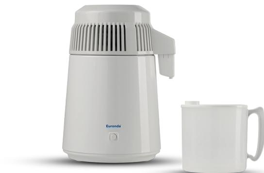
Distillateur d'eau permettant d'obtenir de l'eau distillée par ébullition et condensation ultérieure de la vapeur. Il distille 0,7 l d'eau par heure. Capacité 4 litres. Il répond aux tests de sécurité et de compatibilité électromagnétique (2014/30/UE) et de basse tension (2014/35/UE).
